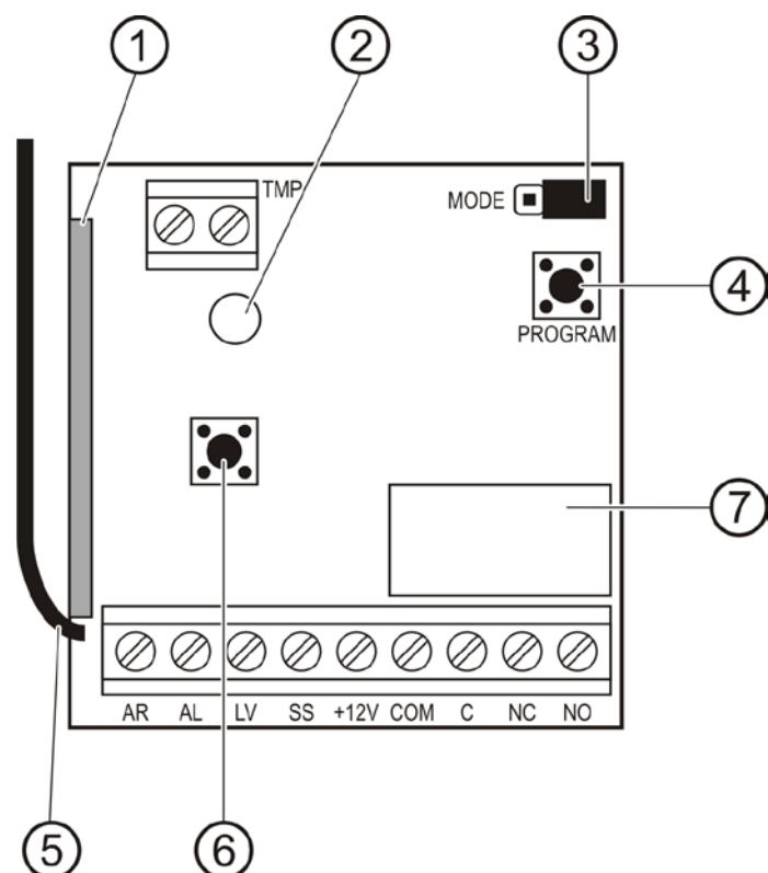
Рис. 1. Вид платы радиоконтроллера RXH-1K.
