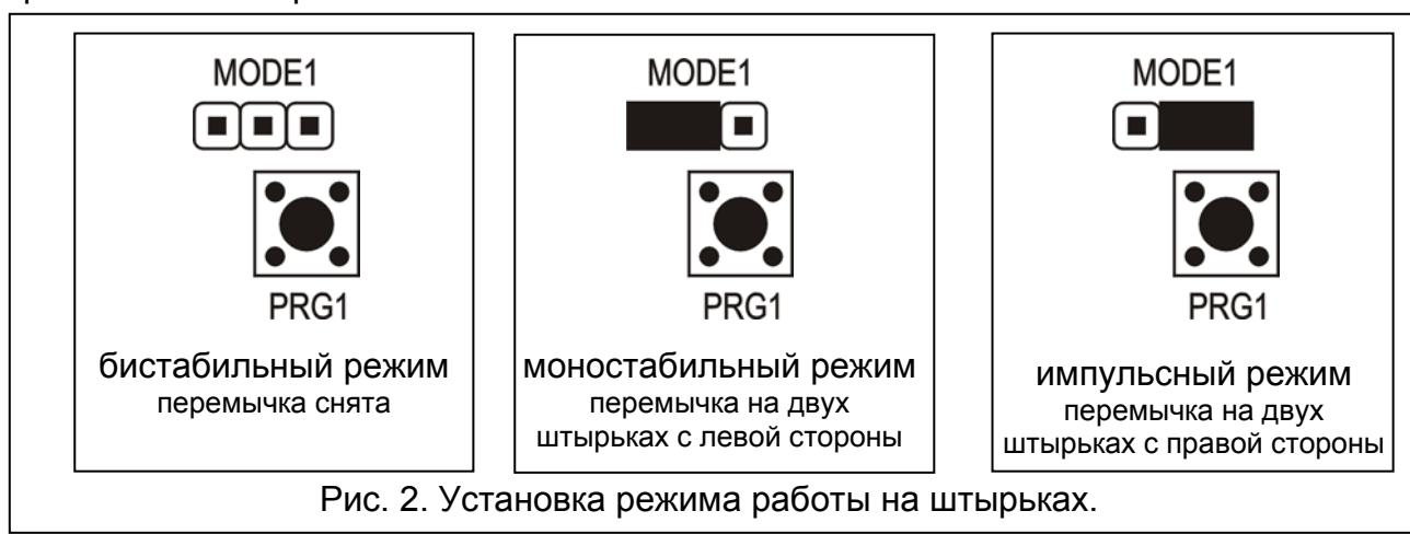
**Бистабильный режим (триггерный)** – каждое нажатие кнопки радиобрелока переключает состояние реле на противоположное.
